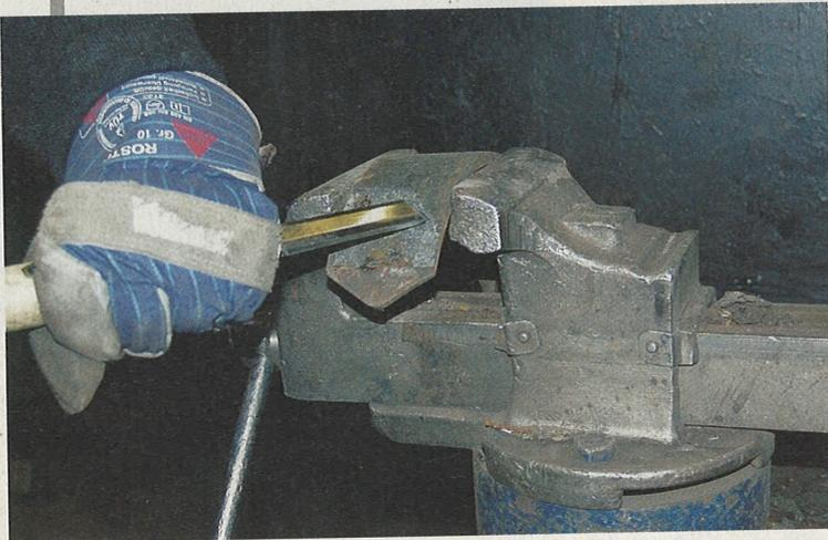
Dem Profi über die Schulter geschaut: Nach der Eingangsprüfung der angelieferten Bremsbacken werden die alten Beläge entfernt
